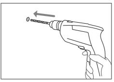
Step3: 在牆上鑽螺絲孔。
