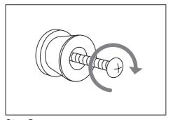
Step5: 把4個固定塊用螺絲固定在牆上。
