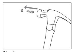
Step4: 將膨脹螺絲嵌入並固定在牆孔內。
