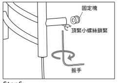
Step6: 把腳套管扣入固定塊後,旋轉小螺絲 鎖緊固定。
