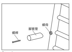
Step1: 通過螺桿將腳套管固定在產品上。
